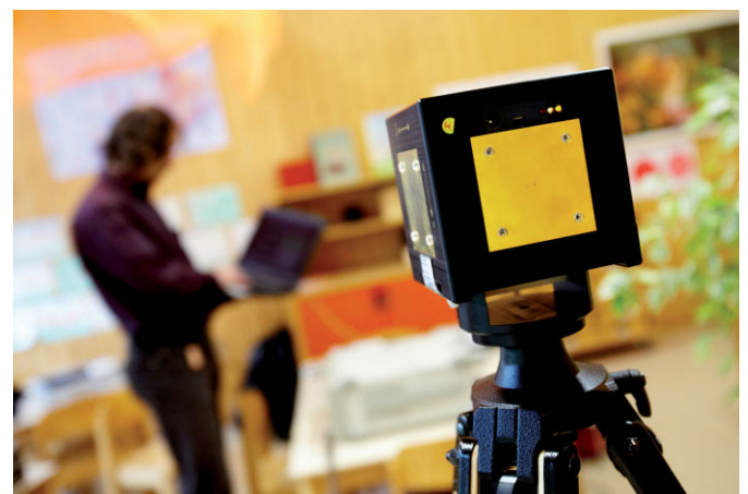
Bild 4. Zur Ermittlung von niederfrequenten elektrischen Feldern wurde an neun Raumpunkten die elektrische Feldstärke ermittelt
